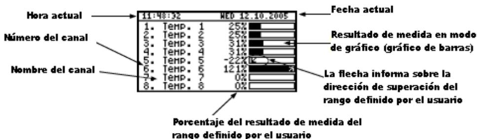
Fig. 6.21. Unidad en el modo de presentación de resultados en "Lista de canales". "Opciones de la lista de canales" parámetro ajustado como "gráfico de barras".
